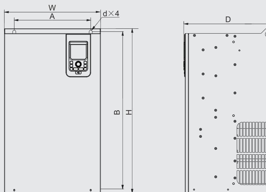
SIZE G~SIZE I 外型尺寸及安装尺寸样式示意图
