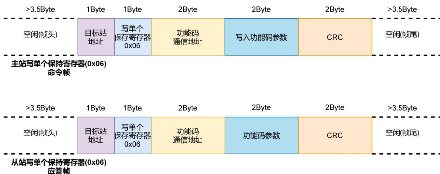
图 9-31 RS485 通信数据帧结构 2
